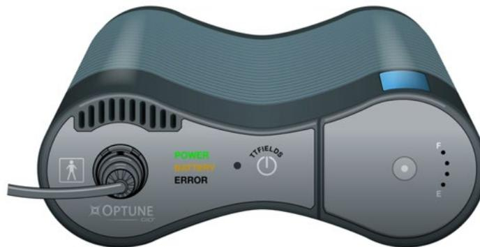
Lorsque votre batterie est épuisée (après environ 2 à 3 heures), le signal de notification retentit et le traitement par TTFIELDS s'arrête. Lorsque cela se produit, le voyant « Battery » (Batterie) devient jaune et le voyant « Error » (Erreur) rouge s'allume. Le son de ce signal de notification est le même que le son émis par le dispositif en cas d'erreur. Cependant, dans ce cas, les deux voyants « Battery » (Batterie) jaune et « Error » (Erreur) rouge s'allument au lieu du seul voyant rouge.
