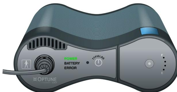
Si une batterie chargée est installée et qu'il n'y a pas de bloc d'alimentation branché, le voyant « Battery » (Batterie) s'allume aussi en vert.
